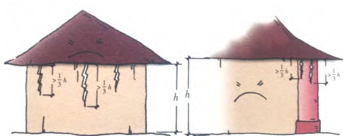
墙、柱产生缝长超过层高1/3的多条竖向裂缝
